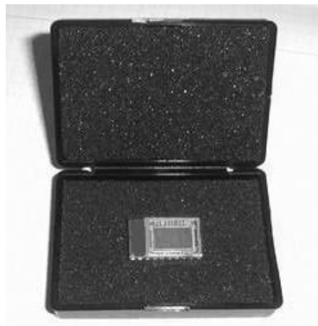
図 2.11: EEV 社製 CCD 素子 (CCD02-06)
